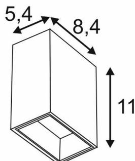
Die mit einer leistungsstarken, warmweissen PowerLED bestückten Wandaufbauleuchte QUAD 1 XL ist in mehreren Farbversionen verfügbar. Der elektrische Anschluss der aus Aluminium gefertigten Leuchte erfolgt durch den verbauten Treiber an 230V Netzspannung. Durch die Schutzart IP44 ist die Leuchte für den Außenbereich geeignet.
